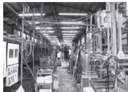
在りし日の水工実験室 左側に開水路 全長40m 可傾式
